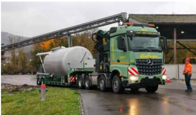
Das neue 40-Kubikmeter-Silo wird auf dem Tieflader angeliefert.
