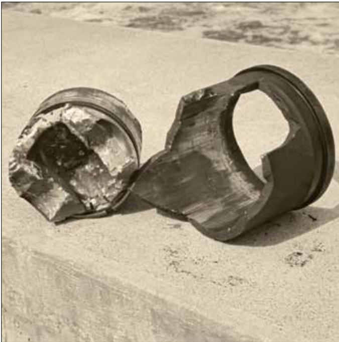
1975 Maschinenbruch «Kolbenfresser» beim Gasmotor
